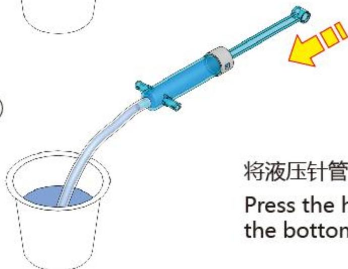
将液压针管压到底部
