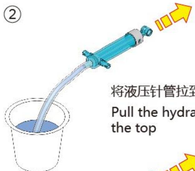
将液压针管拉到顶部
