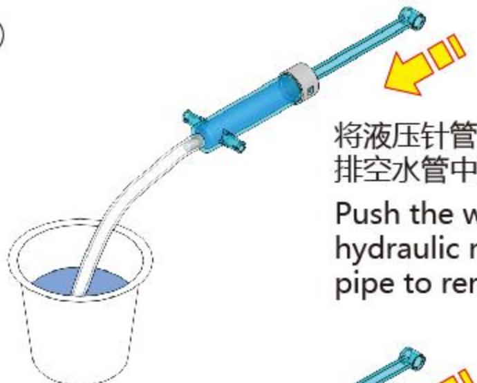
将液压针管内的水推到水管中，
